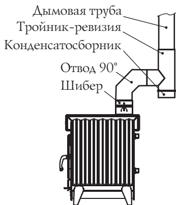
б) дымоход из жаростойкой стали с использованием отвода 90°
