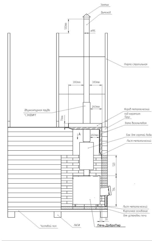
*В целях пожарной безопасности и регулирования газодинамического процесса в работающей печи необходима установка шибера в канал дымохода, в доступном для эксплуатации месте.*
