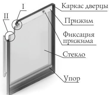
Рисунок 9. Ремонт светопрозрачного экрана дверцы модели «Люмина»
