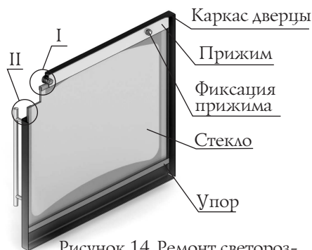
Рисунок 14. Ремонт светорозрачного экрана дверцы модели «Витра»
