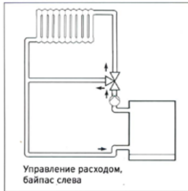
Смесительное регулирование, подмешивание слева
