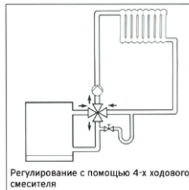
Устройство гидрозатвора в схеме со смесительным регулированием
