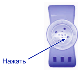
Рис.3. Расположение штока на термовыключателе термостата
