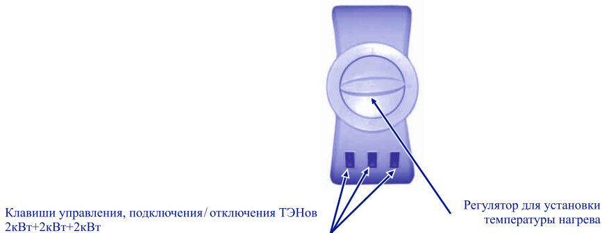
Рис.2. Расположение функциональных кнопок блока управления.
