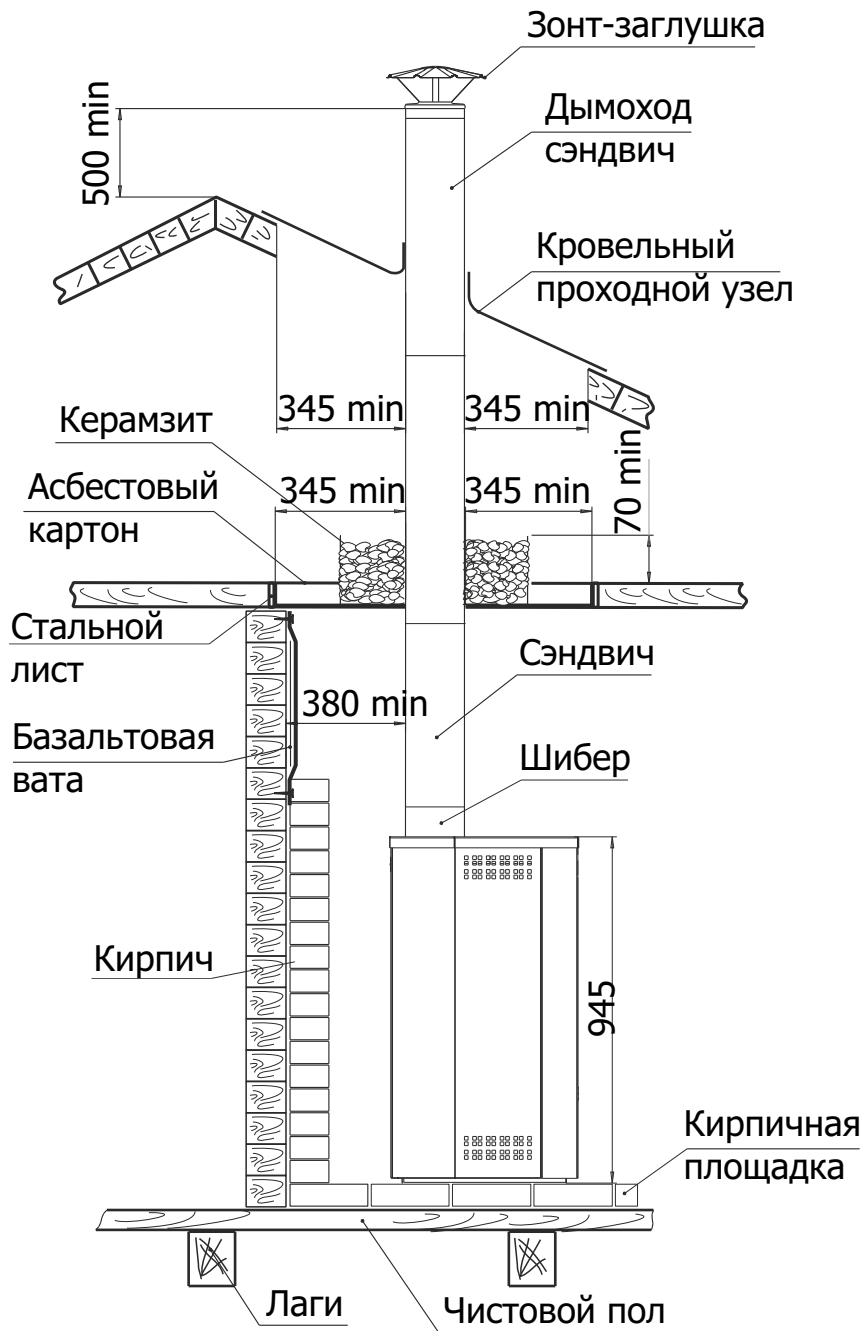
Рис. 2. Схема установки камина и монтаж дымохода
