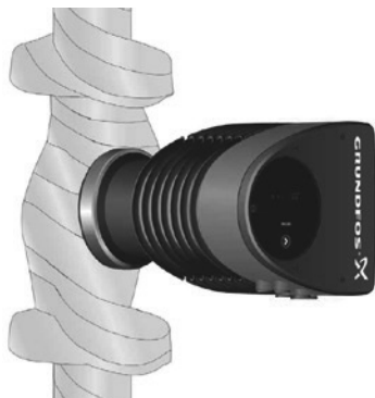
Рис. 17 Изоляция корпуса насоса и трубопровода
