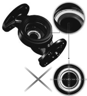
Рис. 15 Неправильно выровненная система уплотнений
