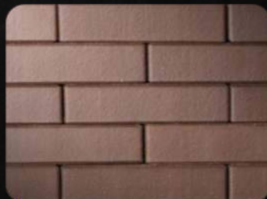
Футеровка топок в базовой комплектации - ШСП
